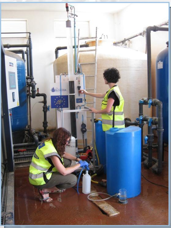
Se han llevado a cabo **diferentes ensayos** con la planta piloto a escala laboratorio **in situ** en la ETAP de **Benizalón**. Esta experimentación ha sido realizada como una etapa previa a la construcción de las plantas piloto en Almería, para la **optimización** de algunos de los parámetros de operación y evaluar la eficiencia de los materiales filtrantes.
