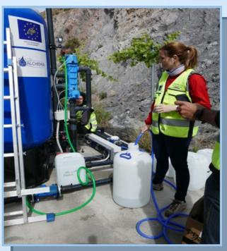
Para verificar el cumplimiento de las normas de calidad del agua potable y el óptimo funcionamiento de las plantas piloto, el equipo de **CIESOL** ha llevado a cabo la **primera toma de muestras** en las etapas de filtrado, lavado y material de relleno de los tanques de filtración.
